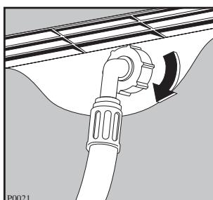
Другой конец наливного шланга, подключающийся к машине, может быть повернут в любом направлении. Ослабьте гайку, поверните шланг и вновь затяните гайку, проверив отсутствие течией воды. Наливной шланг нельзя вытягивать. Если он слишком короткий, и вы не хотите передвигать кран, то вам следует купить новый, более длинный шланг, специально предназначенный для данных целей.
